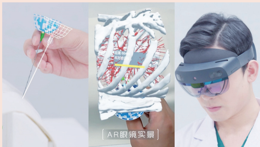
复拓知达精准便携 AR 导航穿刺定位系统可结合计算机视觉单目追踪技术与 AR 显示技术
